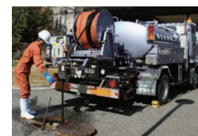
下水道管理施設メンテナンス この車で管路内の詰まり直 しや洗浄を行います。
